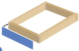
Beim Verkleben ist darauf zu achten, dass die Unterseite eben ist. Sie können zum Beispiel einen Anschlag verwenden. Sollte die Oberfläche dennoch schief sein, können Sie sie durch das Abkleben von 3 Holzstäbchen begradigen.
